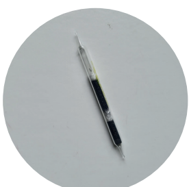
Rør til luftopsamling
