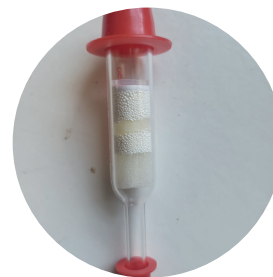
Rør til luftopsamling
