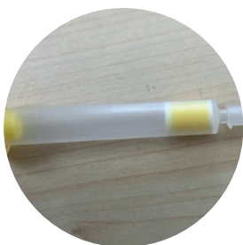
Rør til luftopsamling
